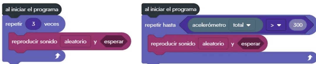
Figura 5. Programación de bucle for (izquierda) y programación de bucle while (derecha) en Sphero Mini.
